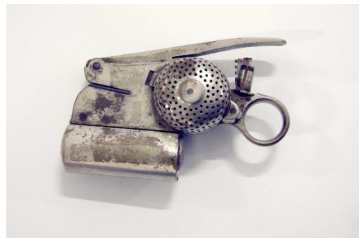
Fig. 1 – Alicate Obliterador, Towle MFG Co. NY. Ptd, 1864
